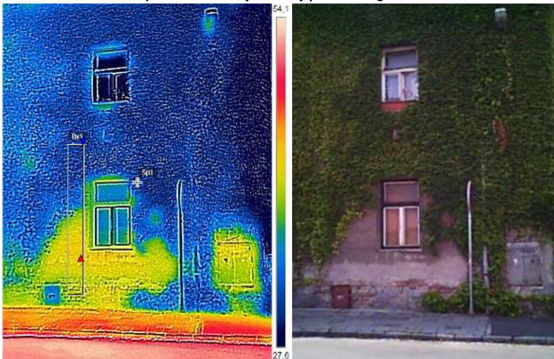
Obrázek 27: Srovnání teplot běžné fasády a fasády porostlé vegetací
